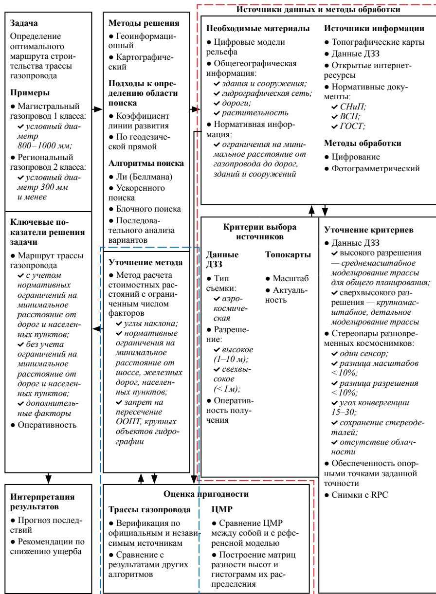
Рис. 47. Схема методики комплексного геоинформационно-фотограмметрического моделирования рельефа для определения оптимального маршрута строительства газопровода
