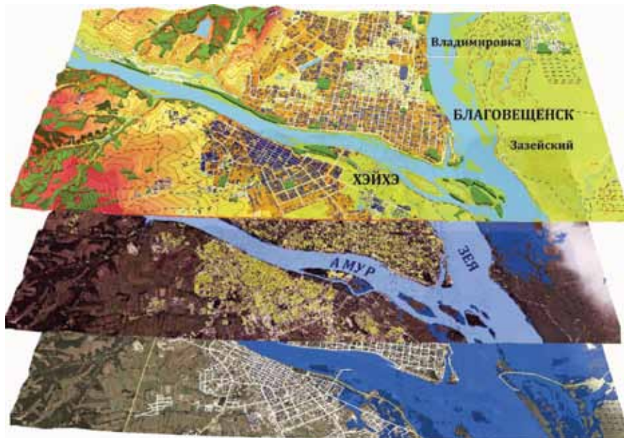
Рис. 39. Перспективная визуализация геоинформационного моделирования наводнения в окрестностях Благовещенска
