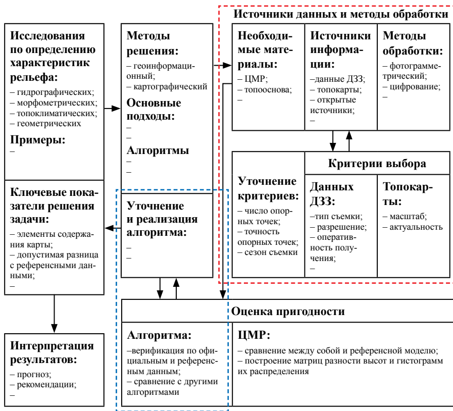
Рис. 9. Общая схема методики комплексного геоинформационно-фотограмметрического моделирования рельефа:
