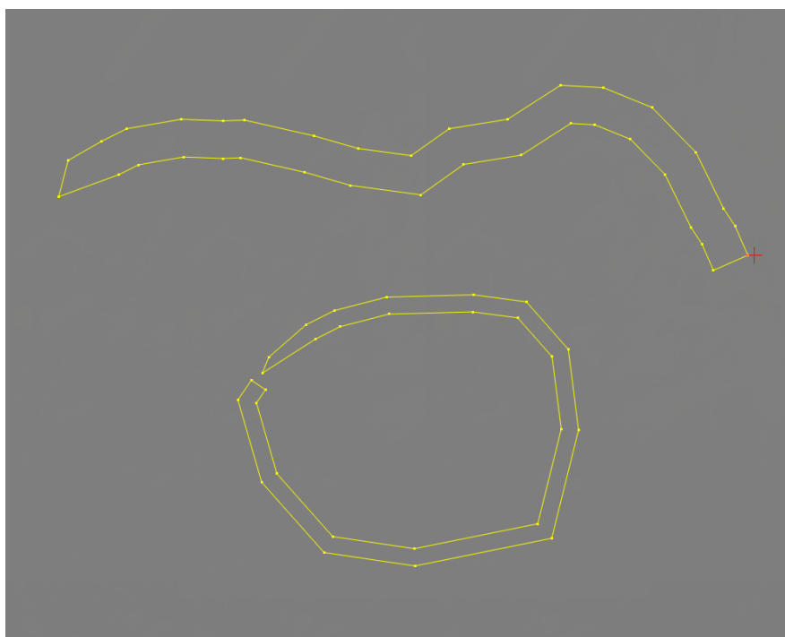
Рис. 177. «Симметричные» площадные объекты созданные при помощи функции Векторы > Геометрия > Симметричные объекты > Полигон
