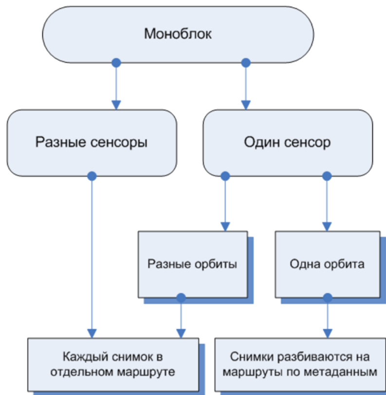
Рис. 38. Схема формирования моноблока в системе
