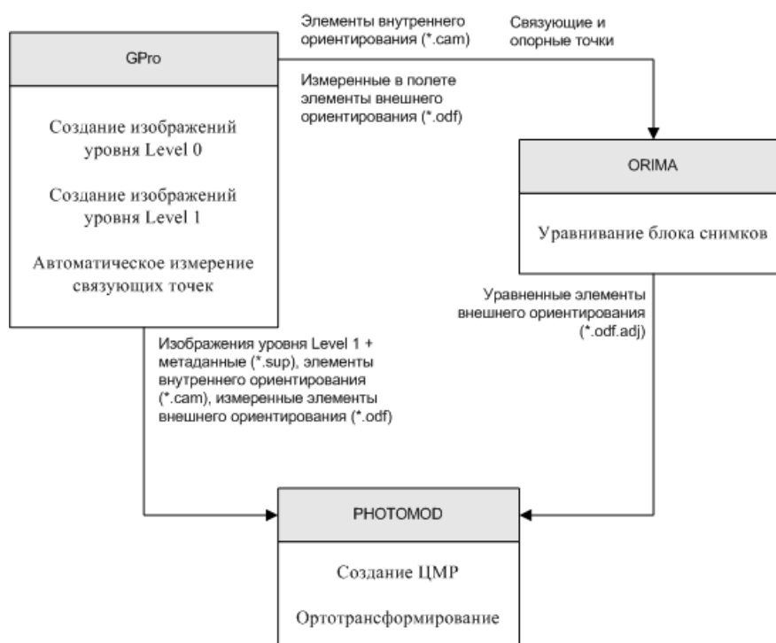
Рис. 10. Технологическая схема предварительной обработки данных ADS
