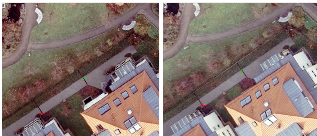
Рис. 123. На левом снимке — триплетная точка, находящаяся в центре тройного перекрытия, на правом — триплетная точка с правого снимка
