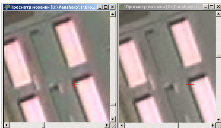
Рис. 112. Результат операции Pan-sharpening методом Brovey без коррекции цвета (слева) и с коррекцией цвета по окрестности (справа). Установленные параметры: размер апертуры – 7, порог каналов RGB – 70.
