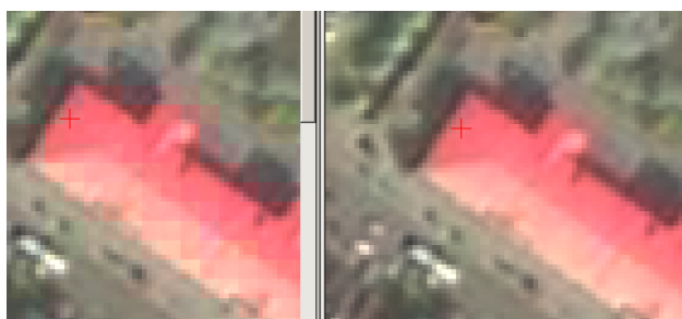
Рис. 104. Результат операции Pan-sharpening методом Brovey без интерполяции цветного растра (слева) и с интерполяцией (справа). При отсутствии интерполяции на полученном изображении явно просматриваются квадратики, соответствующие пикселям исходного цветного растра, что в большинстве случаев нежелательно.
