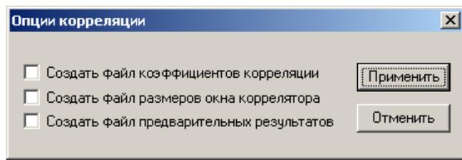
Переключатель **Создать файл коэффициентов корреляции**. При активации этого элемента в папке проекта на каждом уровне обработки создается файл коэффициентов корреляции с названием **<имя проекта>\Results\CorrelationCoefficientsFile.rdp**, который может использоваться для оценки качества файла параллаксов.
