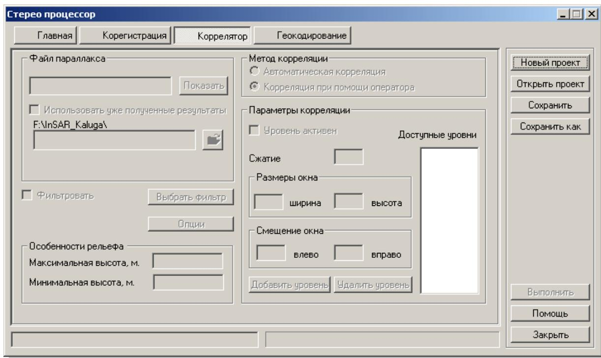
Кнопка **Показать**. Активизируется после выполнения корреляции. Вызов окна просмотра файла разности параллаксов – результата работы коррелятора.
