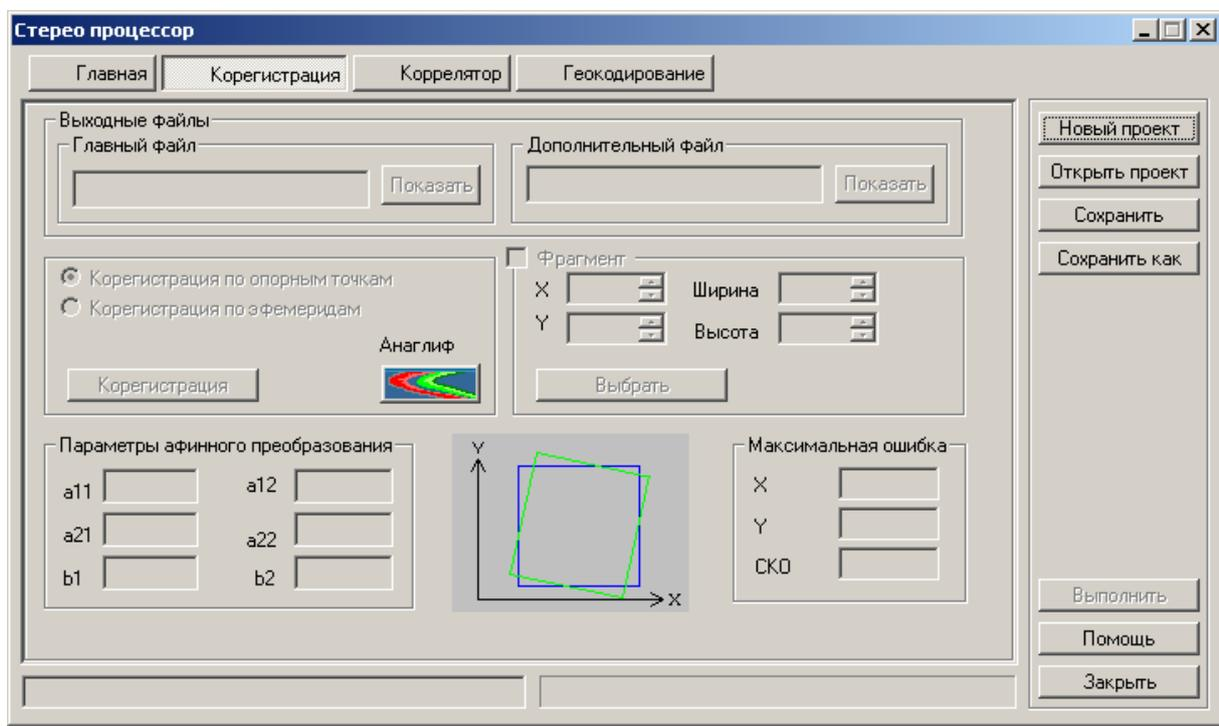
Кнопка **Показать - Основной файл** делается доступной после совмещения изображений. По нажатию этой кнопки происходит вызов окна просмотра основного файла после совмещения его со вспомогательным.
