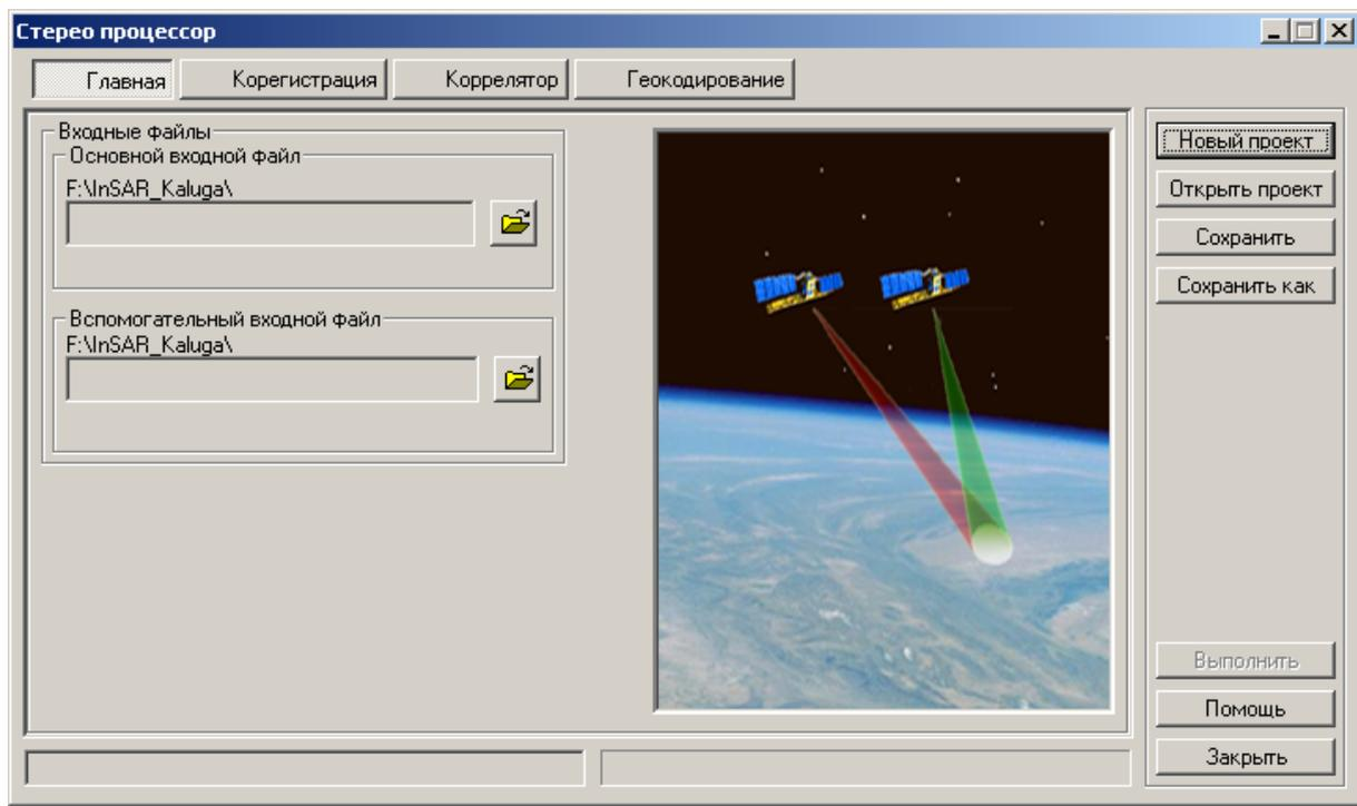
Кнопка **Новый проект**. По нажатию кнопки создается новый файл проекта стерео обработки. Файл проекта содержит в себе набор параметров обработки, устанавливаемых пользователем.
