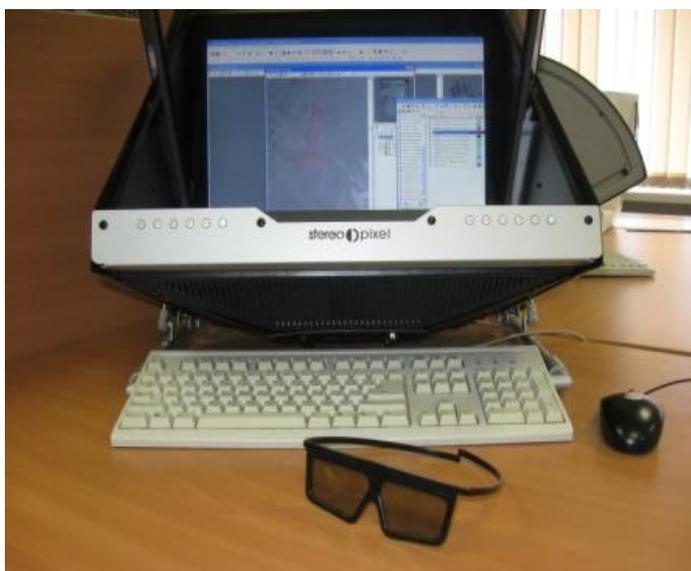
Рис. 1. Стереомонитор Stereo Pixel и поляризационные очки
