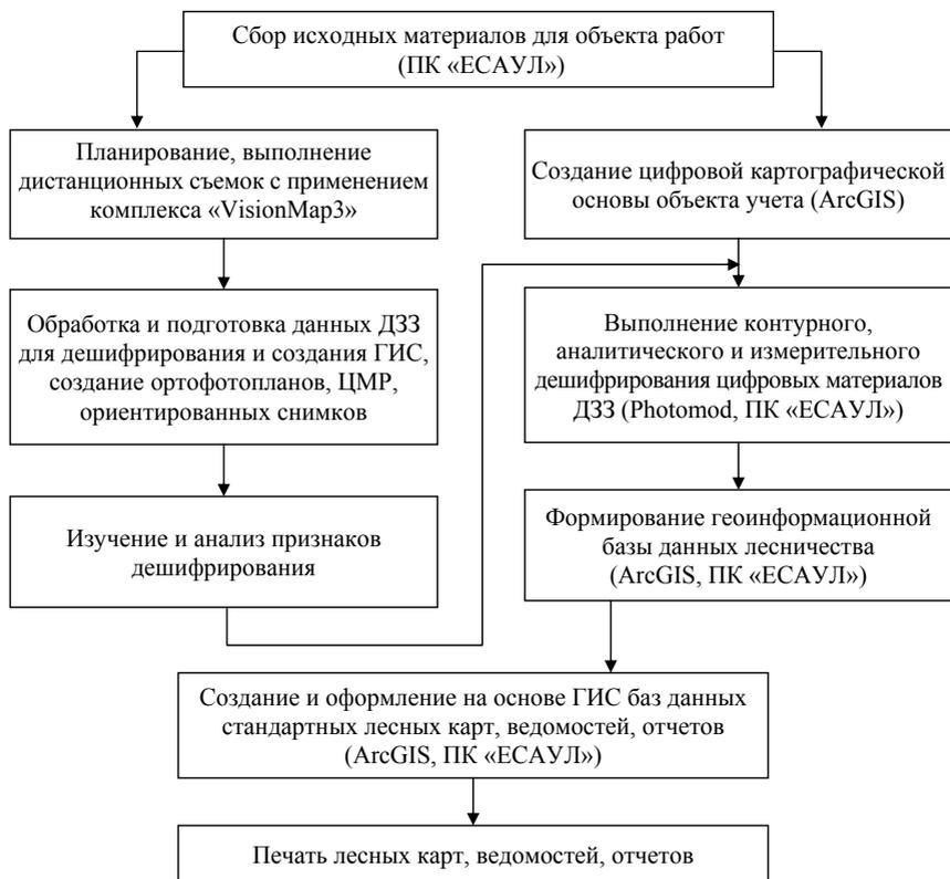
Рис. 1. Схема лесоустроительных работ по технологическому циклу «От съемки – к проекту» с применением фотограмметрического комплекса VisionMap A3, системы Photomod, ПК «ЕСАУЛ», аппаратных комплексов для стереодешифрирования
