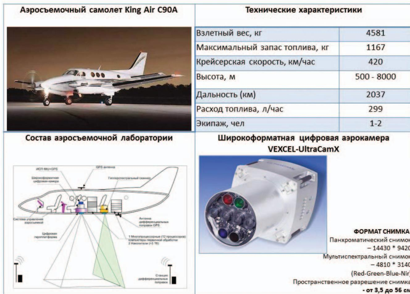
Рисунок 1. Съёмочное оборудование.
