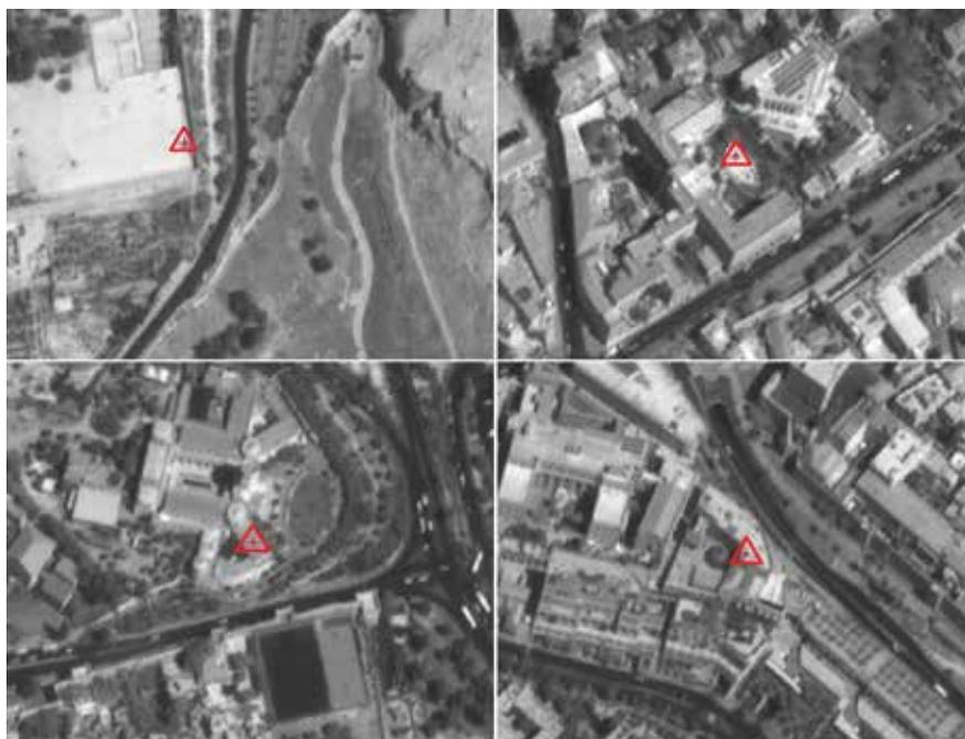
Рисунок 1 – Расположение опорных точек на блоке снимков КА «Ресурс-П»
