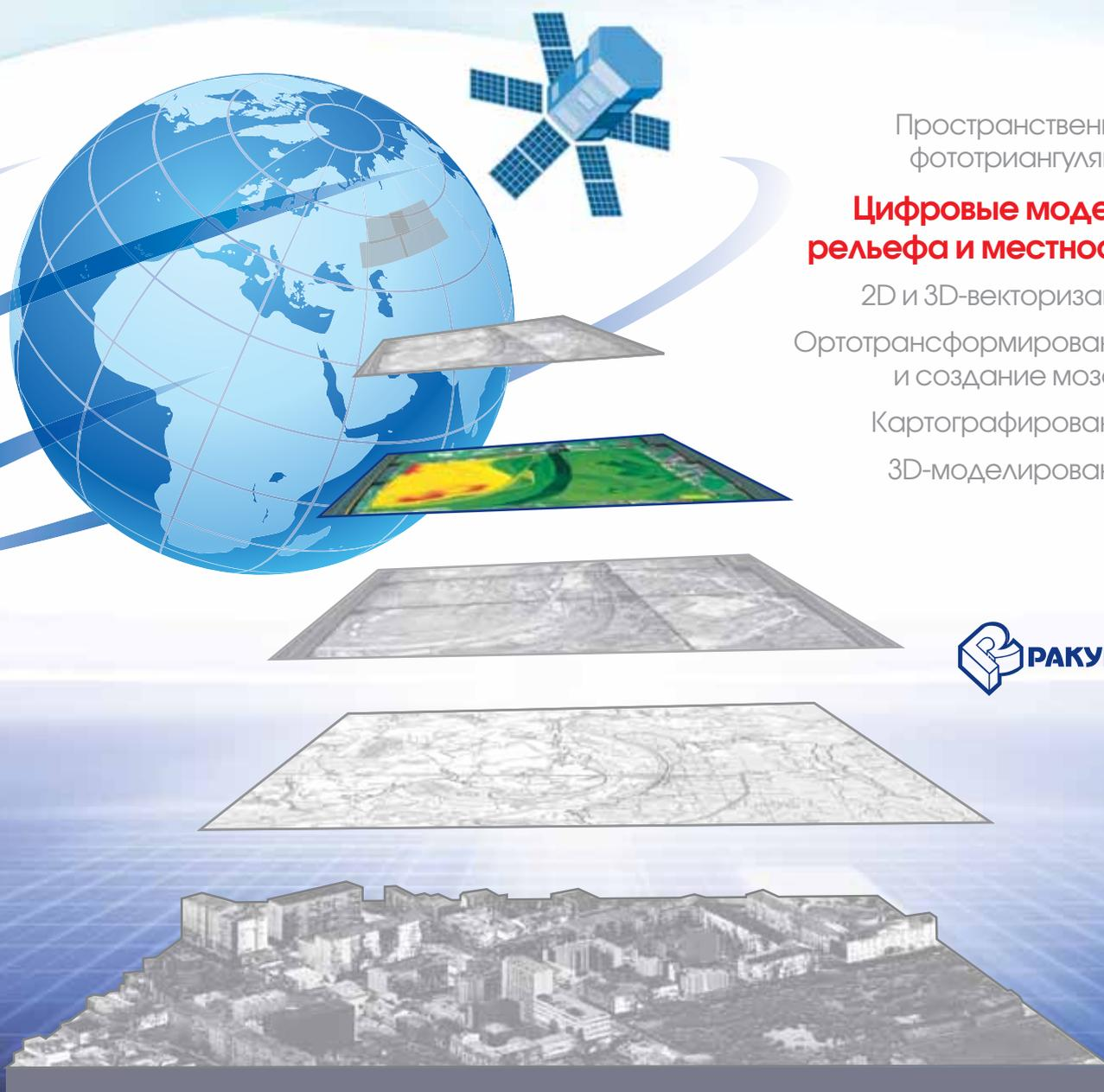
Программный комплекс PHOTOMOD позволяет автоматически строить цифровые модели рельефа по результатам стереообработки блоков аэро- и космических изображений.
