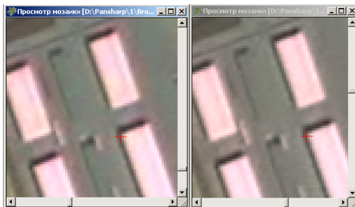
Рис. 72. Результат операции Pan-sharpening методом Brovey без коррекции цвета (слева) и с коррекцией цвета по окрестности (справа). Установленные параметры: размер апертуры – 7, порог каналов RGB – 70.
