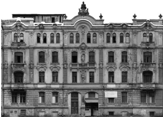
Рис. 2. Конечное “истинное” ортофотоизображение фасада (размер пиксела 6 мм).
