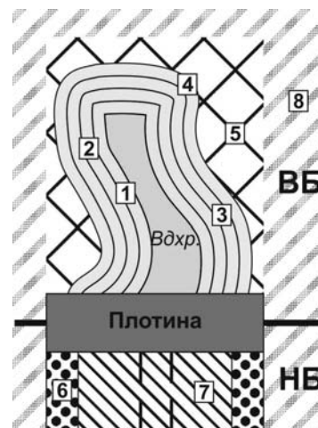
Рис. 2. Зоны водохранилища: 1 — постоянного затопления; 2 — периодического временного затоп- ления; 3 — эпизодического затоп- ления с малой вероятностью повто- рения; 4 — повышенного уровня грунтовых вод; 5 — переформиро- вания берегов; 6 — влияние много- летнего и сезонного регулирования стока; 7 — недельного и суточного регулирования стока; 8 — климати- ческого влияния
