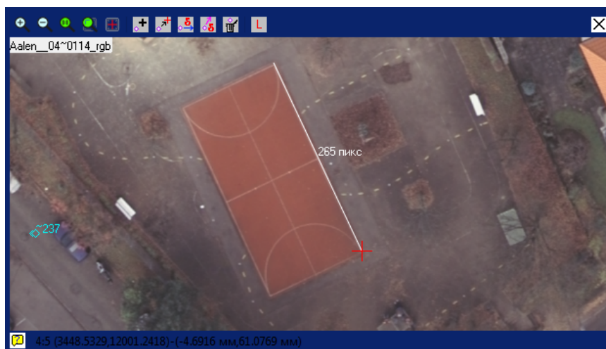
Рис. 43. Измерение расстояний в модуле «Измерение точек»
