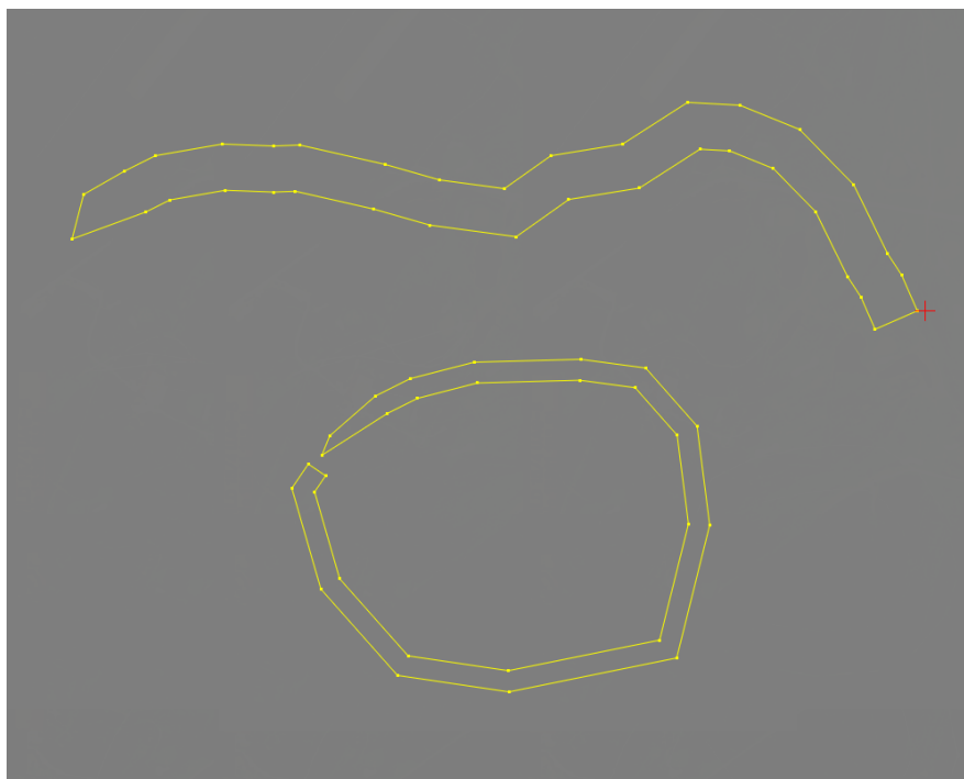
Рис. 174. «Симметричные» площадные объекты созданные при помощи функции Векторы > Геометрия > Симметричные объекты > Полигон
