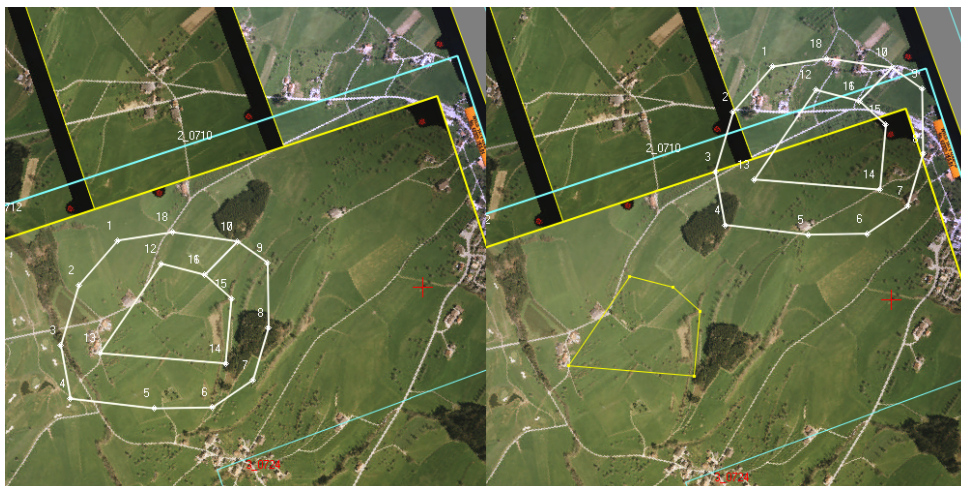
Рис. 202. Результирующий полигон кольцевой формы и внутренний полигон.
