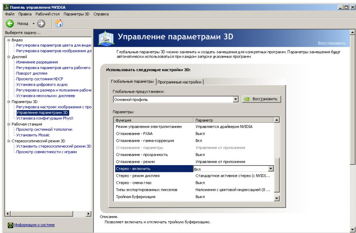
Рис. 27. Настройка стереорежима
