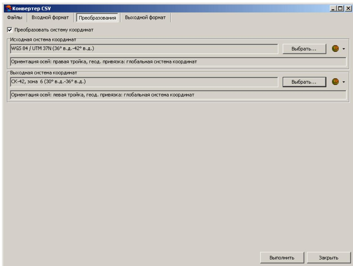
Рис. 147. Выбор исходной и выходной систем координат
