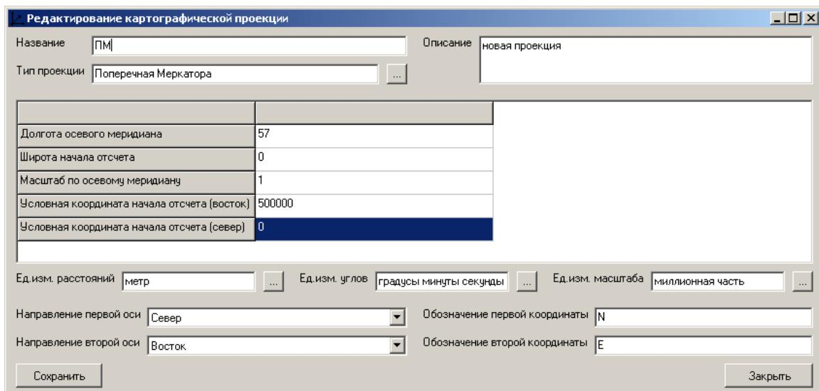
Рис. 139. Пример создания проекции типа поперечная Меркатора с частным масштабом длин равным 1.0
