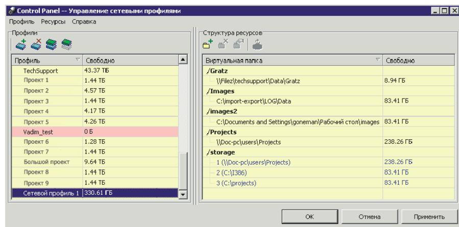
Рис. 77. Пример создания сетевого профиля с подключением группы хранилищ для изображений и отдельного сервера для проектных файлов
