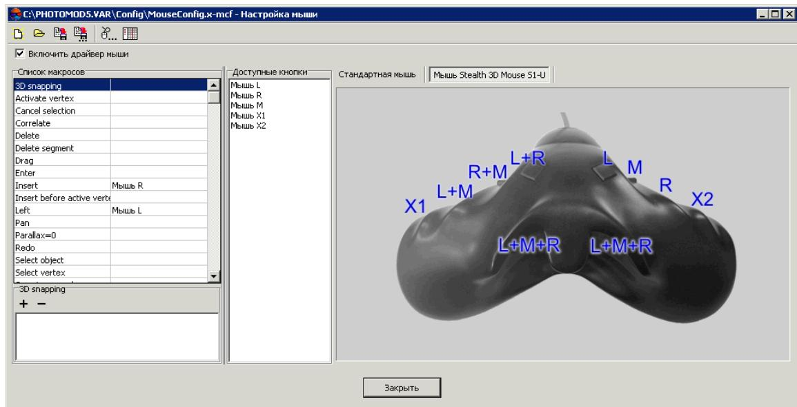
Рис. 39. Окно настроек кнопок мыши *Stealth 3D Mouse S1-U*
