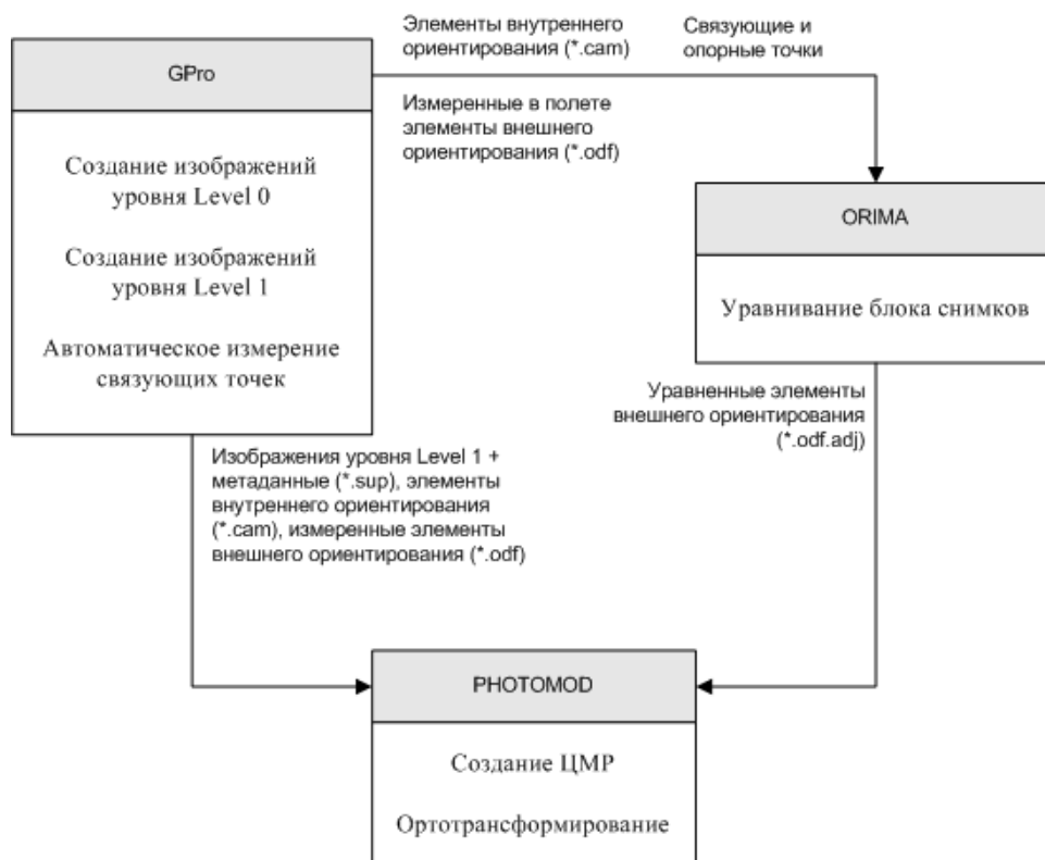
Рис. 8. Технологическая схема предварительной обработки данных ADS
