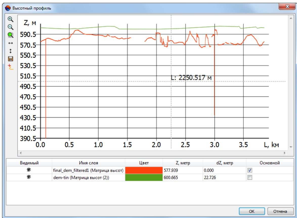
Рис. 220. Окно высотного профиля матриц высот вдоль линейного объекта
