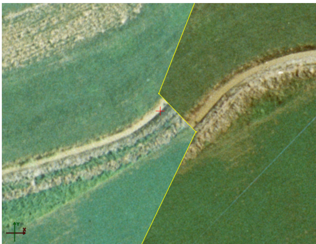
Рис. 77. Элементы протяженного объекта (дороги), плохо совмещенные друг с другом на смежных снимках
