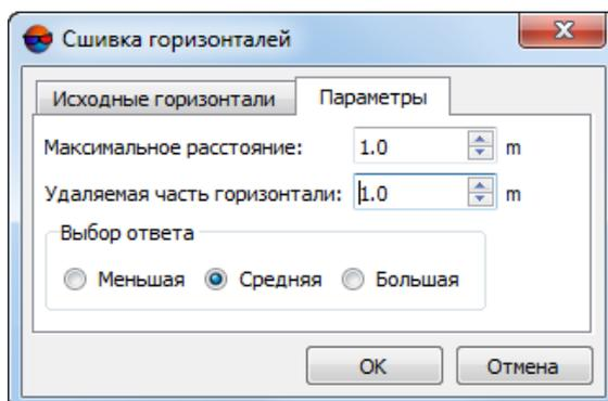
Рис. 98. Параметры сшивки горизонталей на закладке «Параметры»
