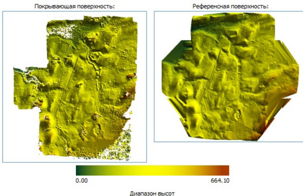
Рис. 247. Отчет с результатами вычисления объемов (референсная поверхность - плоскость с постоянной высотой);
