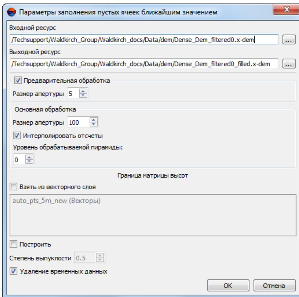
Рис. 164. Параметры восстановления пустых ячеек матрицы высот
