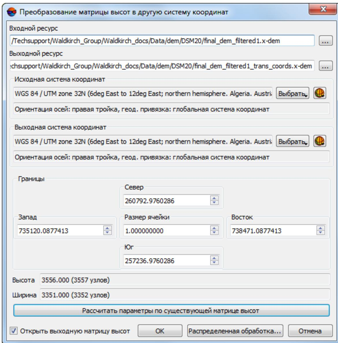
Рис. 155. Преобразование матрицы высот в другую систему координат
