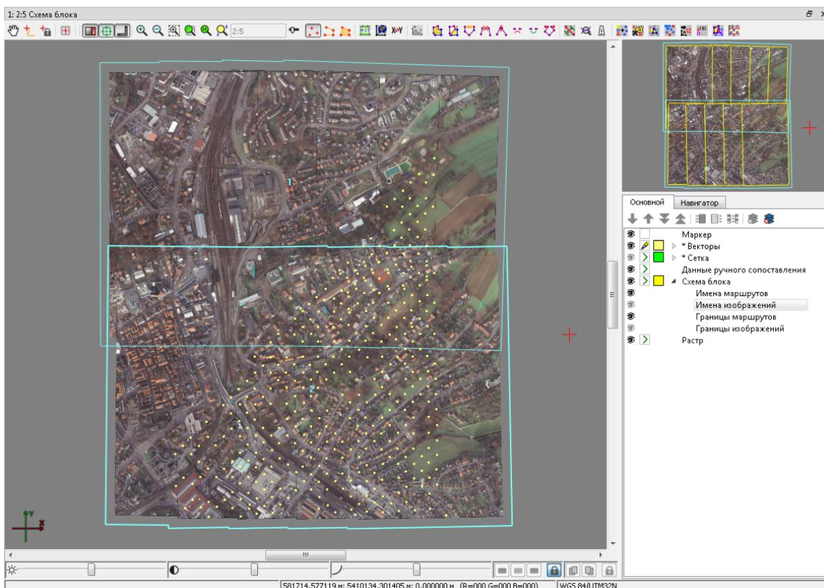
Рис. 6. Автоматический расчет пикетов на произвольной области
