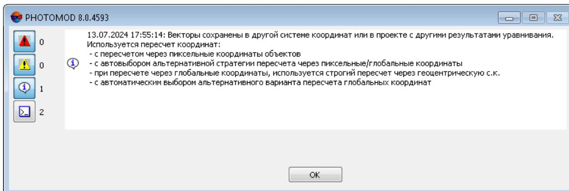
Рис. 37. Пересчет координат при загрузке векторного слоя
