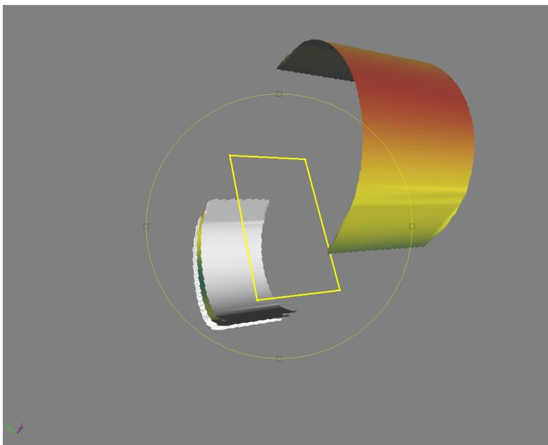
Рис. 216. Входная матрица высот (сверху), поверхность с постоянной высотой равной нулю (обозначена прямоугольным полигоном), выходные матрицы высот, построенные с различными значениями параметра **Постоянная высота** (внизу)
