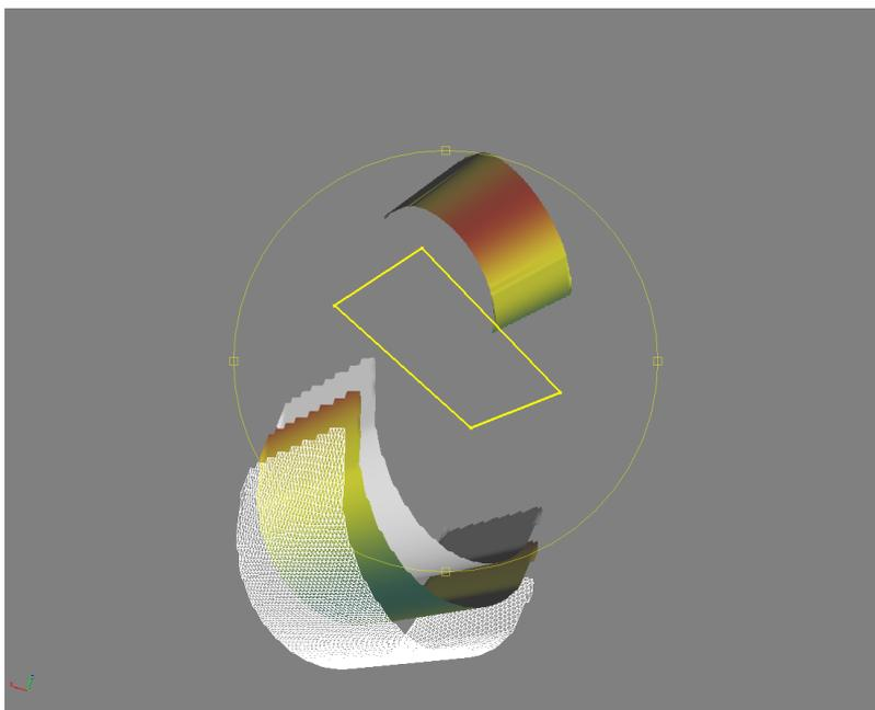
Рис. 215. Входная матрица высот (сверху), поверхность с постоянной высотой равной нулю (обозначена прямоугольным полигоном), выходные матрицы высот, построенные с различными значениями параметра **Постоянная высота** (внизу)
