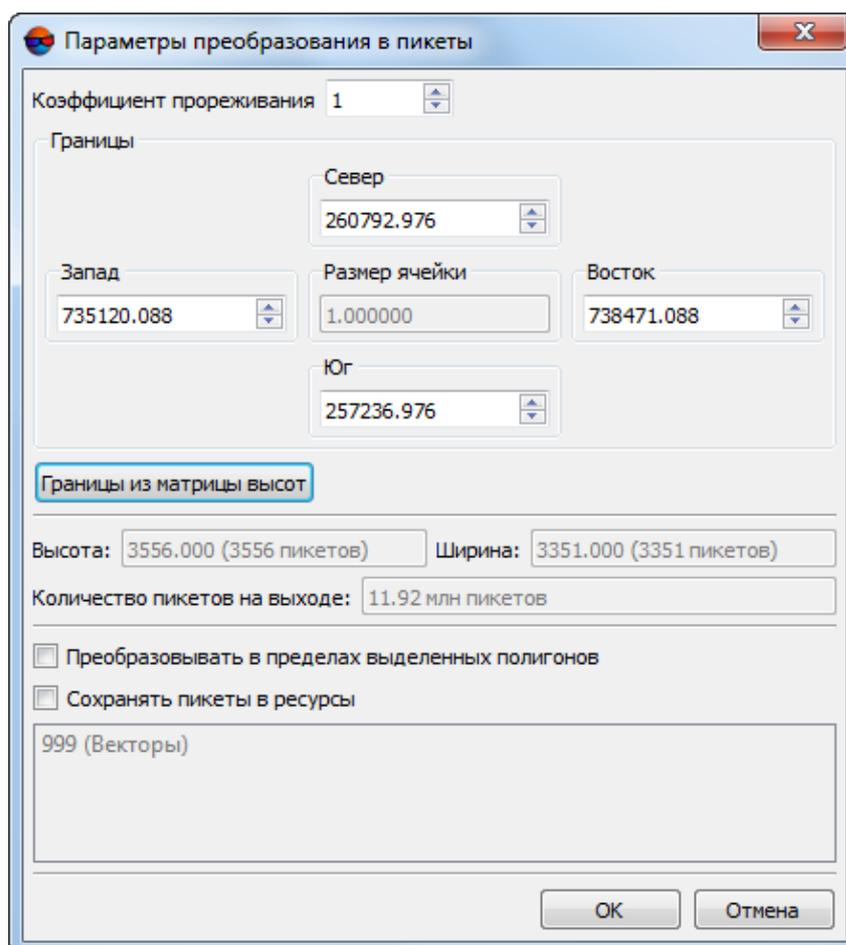
Рис. 184. Параметры преобразования матрицы высот в пикеты
