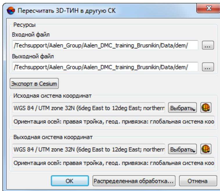
Рис. 83. Преобразование 3D-TIN в другую систему координат
